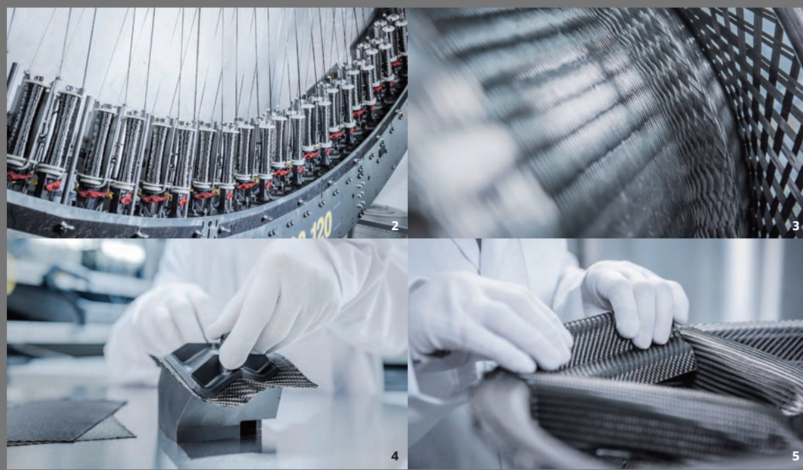
1, 2, 3, 4, 5 포르쉐는 제조 공법을 개선해 카본 휠 생산성을 조금 더 끌어올렸다. 원형의 직기를 이용해 림을 만든 후 스포크는 탄소섬유 천을 잘라서 붙인다.
