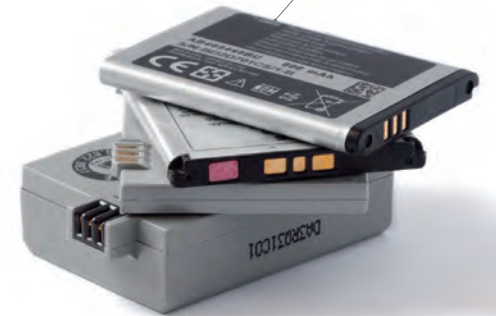
소형 전자기기의 배터리는 거의 공통적으로 3.7~3.8V의 전압을 사용하며 간단히 mAh(전류량)로 용량을 표기한다.
