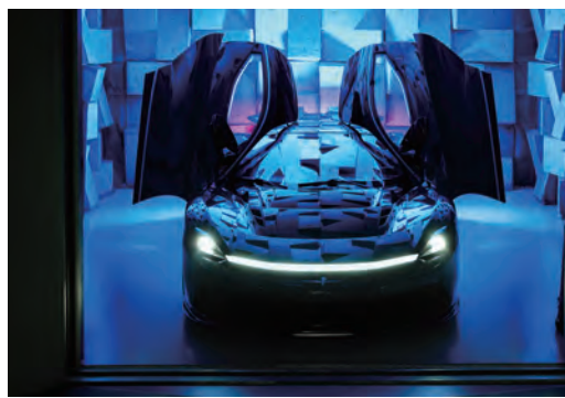
1 아우디는 생활 속의 도구가 내는 소리를 재집해 e-트론 GT를 위한 ‘e-사운드’를 만들어냈다. 2,3 피닌파리나는 지난 4월 전기 하이퍼카 바티스타에 적용할 사운드 콘셉트 ‘수오노 푸로’—영어로는 ‘퓨어 사운드’—를 공개했다. 기본 공명음은 54Hz.
